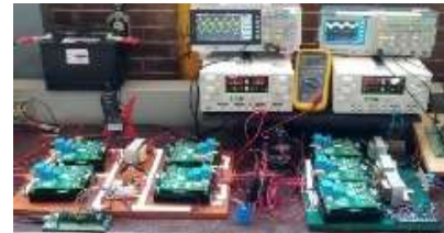
Figura 4. Prototipo de carga y descarga de baterías, DAB.
